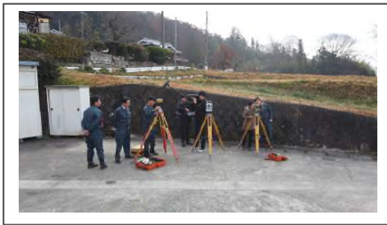
取材状況:トランシット ⇒ トータルステーション ⇒ GPS 測量機
